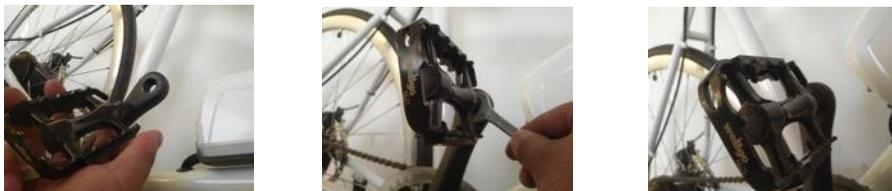
Figura 3 – Montaggio dei pedali.
