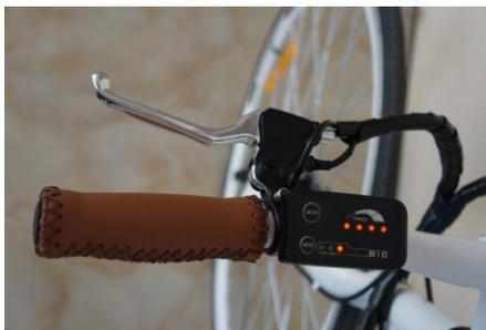
Figura 10 – Led visualizzazione carica batteria e accensione.
