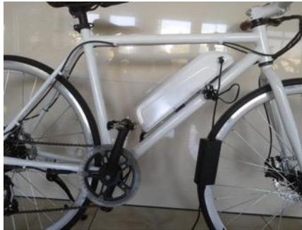
Figura 14 – Cavo del carica batterie collegato alla batteria d'alimentazione della bicicletta.
