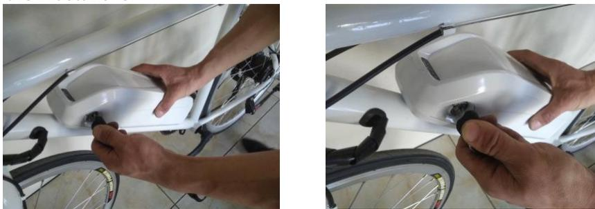
**Figura 12 – Batteria d'alimentazione e dispositivo di blocco con la relativa chiave.**
