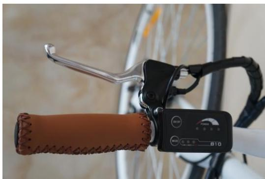
**Figura 16 – Visualizzatore del livello di carica della batteria.**
