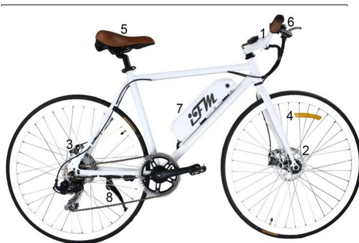
Figura 6 – Parti principali della bicicletta elettrica I FOR ME.
