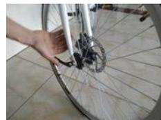
Figura 2 – Montaggio della ruota anteriore.
