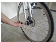
Figura 2 – Montaggio della ruota anteriore.
