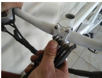
Figura 4– Montaggio del manubrio della bicicletta.
