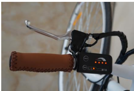
Figura 10 – Led visualizzazione carica batteria e accensione.
