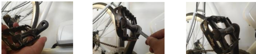
Figura 3 – Montaggio dei pedali.
