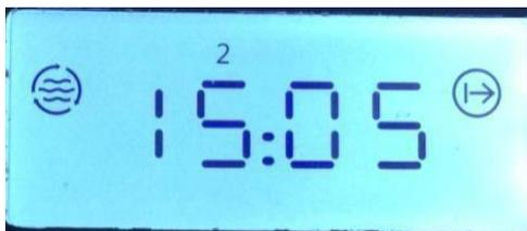
Interfaccia di impostazione dell'ora di avvio dell'intervallo 2 del ciclo dell'acqua temporizzato.
