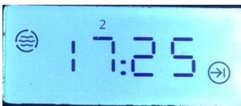
Interfaccia di impostazione dell'ora di termine dell'intervallo 2 del ciclo dell'acqua temporizzato.
