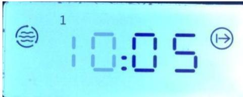
Interfaccia di impostazione dell'ora di avvio dell'intervallo 1 del ciclo dell'acqua temporizzato.
