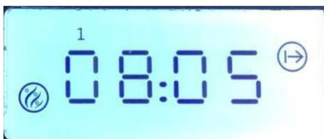
Interfaccia di impostazione dell'ora di avvio dell'intervallo 1 del riscaldamento temporizzato.
