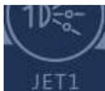
21 Con il sistema di controllo in funzione, se la pompa 1 è impostata come pompa monovelocità, premendo questo tasto è possibile spegnerla e accenderla. Se la pompa 1 è impostata come pompa a due velocità, premendo questo tasto è possibile cambiare lo stato della pompa fra bassa velocità, alta velocità o spegnimento.
