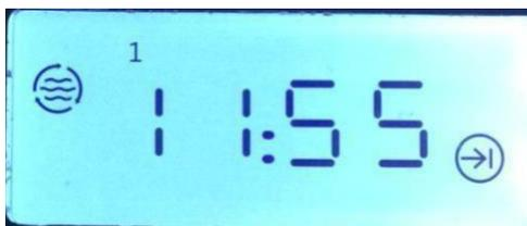
Interfaccia di impostazione dell'ora di termine dell'intervallo 1 del ciclo dell'acqua temporizzato.
